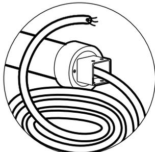
**VERLÄNGERN SIE DAS MOTORKABEL NUR MIT DEM ORIGINALKABEL IN EINER GEHÄRTETEN ABZWEIGDOSE**
